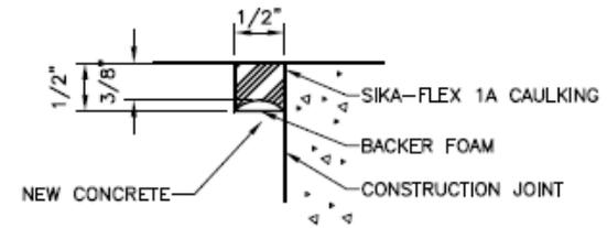
**TYPICAL CONSTRUCTION JOINT CAULKING DETAIL**
