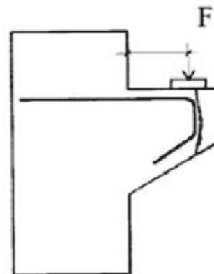
(d) Loss of anchorage of main tie reinforcement
